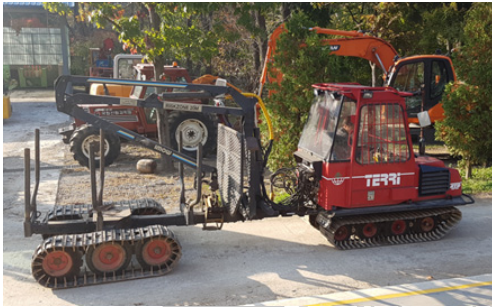
(a) 궤도형 차체굴절식의 임업용 포워더(조이스틱 조향 장치)
