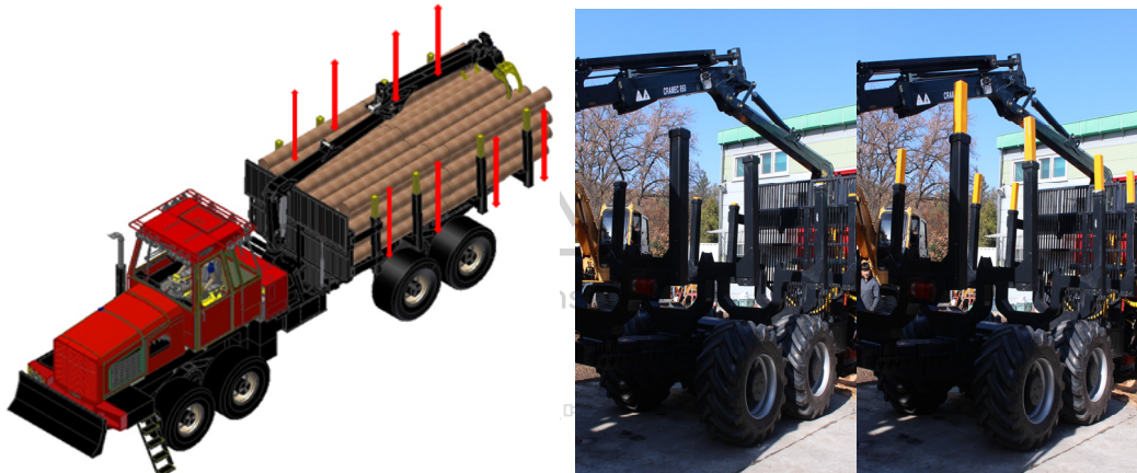
〈그림 68〉 임업용 포워더의 적재함 가변식 적재플 구조 적용
