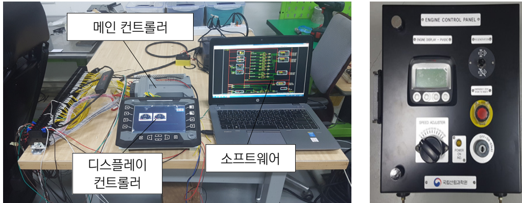
(a) 포워더 제어를 위한 CAN통신 기반 시스템 구축
