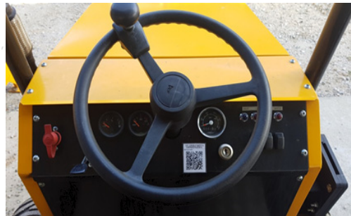
(b) 차륜형 차체굴절식의 임업용 포워더(스티어링 조향 장치)
