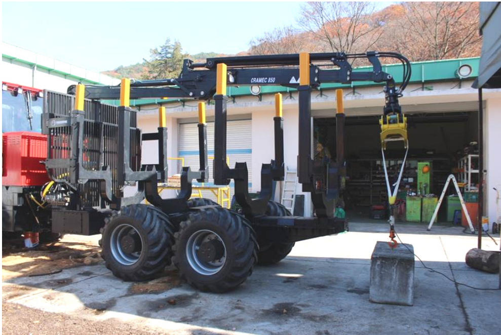
〈그림 52〉 임업용 크레인의 인양능력 측정
