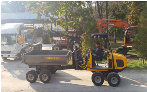
(b) 차륜형 차체굴절식의 임업용 포워더(스티어링 조향 장치)
