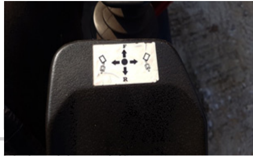
(a) 궤도형 차체굴절식의 임업용 포워더(조이스틱 조향 장치)
