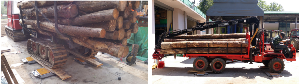
〈그림 12〉 임업용 포워더의 축하중(전·후륜)비 측정조사(좌 : 궤도형, 우 : 차륜형)
